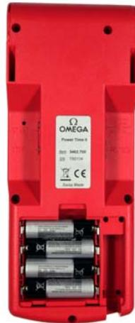
Entfernen sie die vier Batterien. Diese können sie in einer Sammelstelle für Batterien abgeben.
